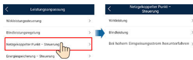
Abbildung 7-10 Netzgekoppelter Punkt – Steuerung
