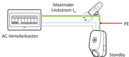
5. Stecken Sie den Ladestecker in die Wallbox und starten Sie den Aufladevorgang. Messen Sie mit der gleichen Methode den maximalen Leckstrom des vorgeschalteten PE-Kabels  $I_B$ .
