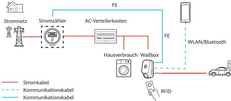
Abbildung3: Stromzähler direkt mit dem Router verbunden, Wallbox über den FE-Port mit dem Router verbunden und dann mit der Cloud-Plattform verbunden.
