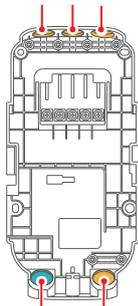
Kommunikations- Stromkabeleinführung kabeleinführung
